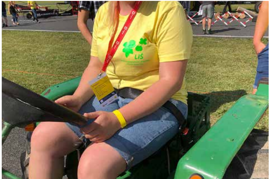
Prikaz naknadne namestitve varnostnega pasu na sedež starejšega traktorja (v konkretnem primeru starodobnika, prireditev NeVarno s traktorjem, Vransko 2021).
