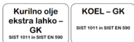
Slika 2. Tablica (nalepka) v dveh različicah za točilno mesto za gorivo za kmetijstvo (Kurilno olje ekstra lahko – GK). Slika je iz predloga standarda SIST 1011.
